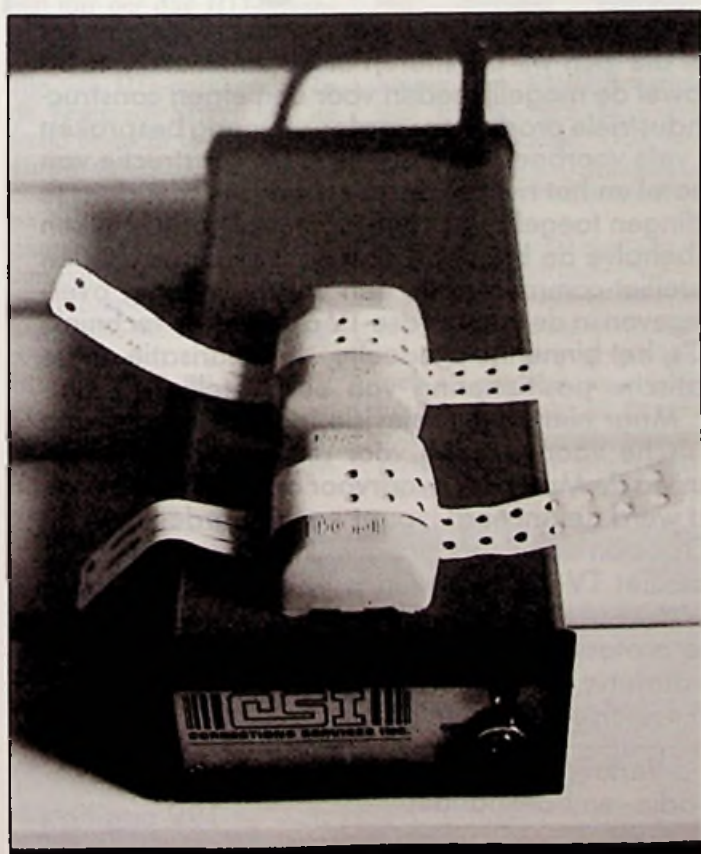
Afb. 4 De ontvanger, van hetzelfde systeem, is via een telefoonverbinding gekoppeld aan een computer.
